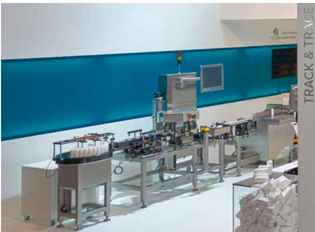
TQS-CP-Bottle: Zuverlässige 360°-Runduminspektion zur semi-automatischen Aggregation
