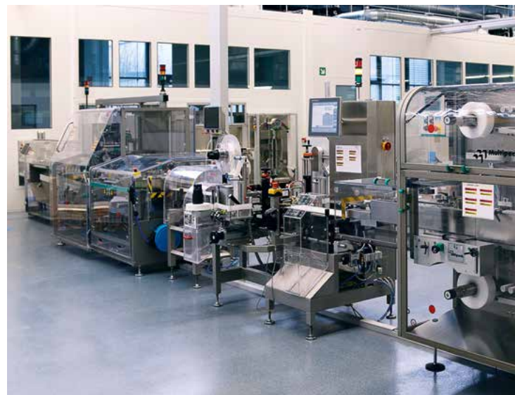
TQS-HC-A bei Acino in Aesch, Schweiz: Serialisierung, Gewichtsinspektion und Tamper-Evident-Funktionalität auf kleinster Stellfläche
