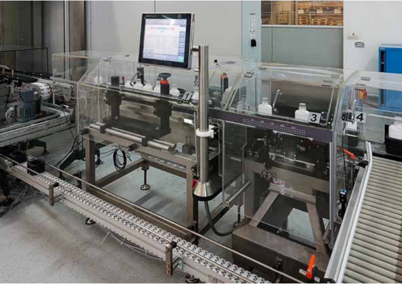
HC-A Kontrollwaage mit einteiligen, RFID-bestückten Produktträgern für den Produkttransport
